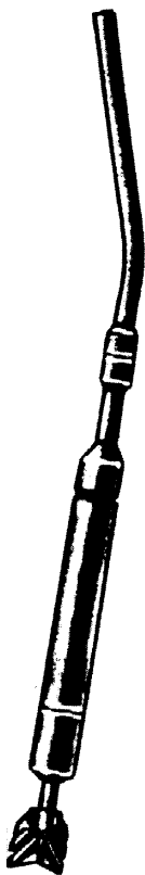
Рис. 2. Клиновой отклонитель
